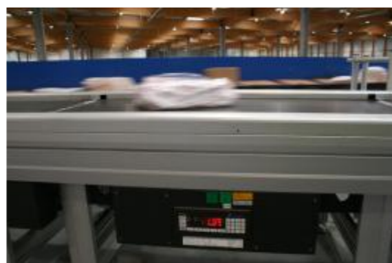
Les colis sont pesés automatiquement sur le tapis roulant
